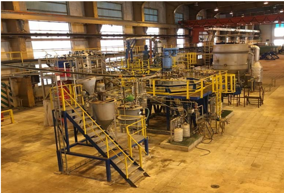
Figuren viser den gamle silika piloten med en reaktor på 1\text{m}^3 . Den nye piloten blir bygget med en reaktor på 6\text{m}^3
